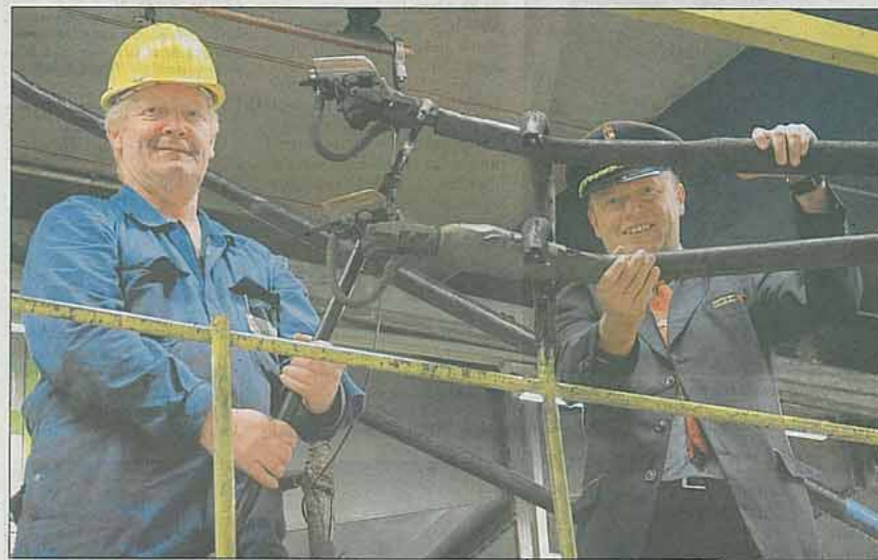
Kein O-Bus kommt an ihm vorbei: StadtBus-Urgestein Hermann Ebner (links) sieht sich jeden Stromabnehmer genau an. Betriebsleiter Ing. Markus Perberschlager (r.) weiß, warum das so wichtig ist: „Die Schleifkohle ist der gut leitende Teil zwischen Stromleitung und dem Fahrdraht. Und sie schmiert die Stromleitung.“
